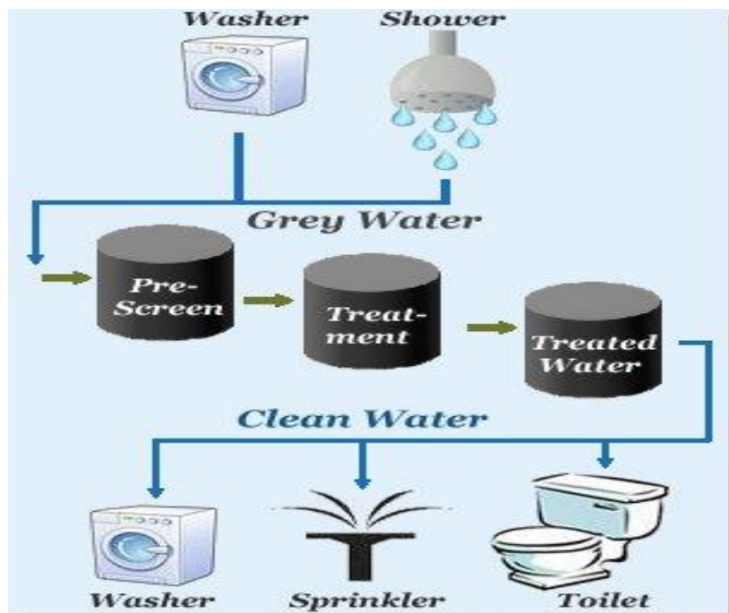
تصویر شماره ۲- فرایند تبدیل مجدد آب خانگی از طریق آب خاکستری
